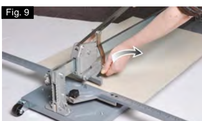
Fig 9 & 10 Lors de l'utilisation du petit système de casse, appuyez progressivement jusqu'à ce que le carreau soit complètement cassé.
