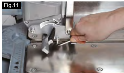
Fig 11&12 Remplacer la molette si elle est usée.
