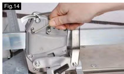
Fig 14 Resserrer progressivement le chariot comme indiqué.
