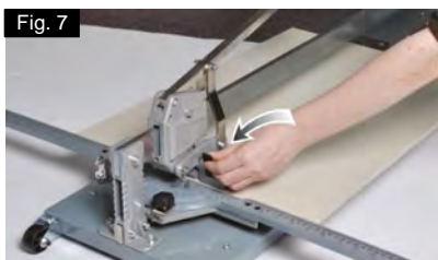
Fig 7 & 8 Bij gebruik van het grote breeksysteem, duwt u doorlopend harder tot de tegel volledig gebroken is.
