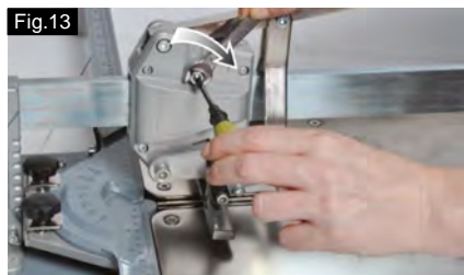
Fig 13 Resserrer le levier du chariot comme indiqué.
