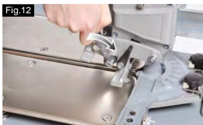
Fig 14 Resserrer progressivement le chariot comme indiqué.
