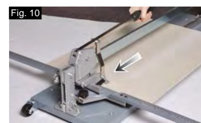
Fig 9 & 10 Cuando utilice el sistema pequeño de corte, apoye progresivamente hasta que la baldosa esté completamente cortada.
