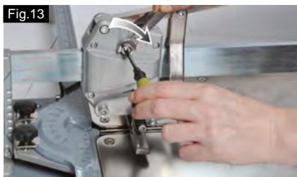
Fig 13 Resserrer le levier du chariot comme indiqué.
