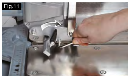
Fig 11&12 Remplacer la molette si elle est usée.
