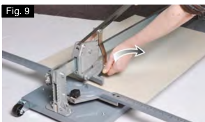
Fig 9 & 10 Bij gebruik van het kleine breeksysteem, duwt u doorlopend harder tot de tegel volledig gebroken is.
