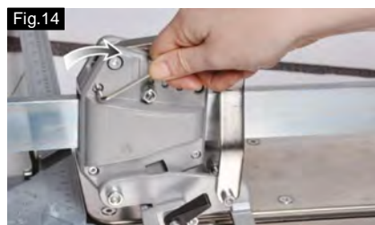
Fig 14 Resserrer progressivement le chariot comme indiqué.
