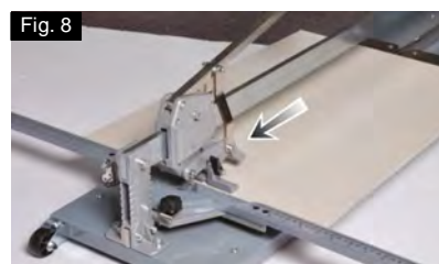
Fig 7 & 8 Lors de l'utilisation du grand système de casse, appuyez progressivement jusqu'à ce que le carreau soit complètement cassé.
