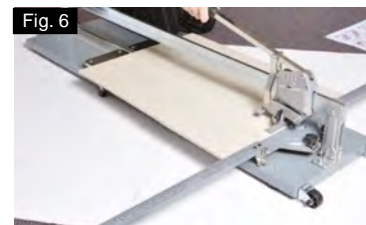
Fig 7 & 8 Lors de l'utilisation du grand système de casse, appuyez progressivement jusqu'à ce que le carreau soit complètement cassé.
