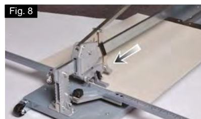
Fig 7 & 8 Cuando utilice el sistema grande de corte, apoye progresivamente hasta que la baldosa esté completamente cortada.
