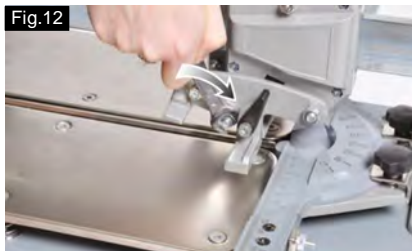
Fig 14 Resserrer progressivement le chariot comme indiqué.
