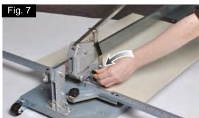
Fig 7 & 8 Cuando utilice el sistema grande de corte, apoye progresivamente hasta que la baldosa esté completamente cortada.
