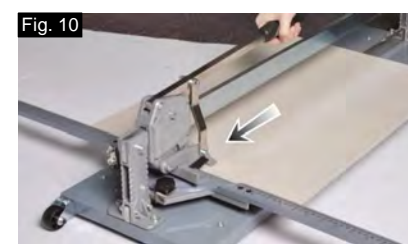
Fig 9 & 10 Lors de l'utilisation du petit système de casse, appuyez progressivement jusqu'à ce que le carreau soit complètement cassé.
