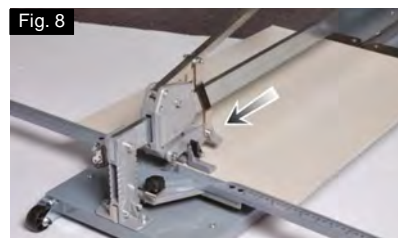
Fig 7 & 8 Bij gebruik van het grote breeksysteem, duwt u doorlopend harder tot de tegel volledig gebroken is.
