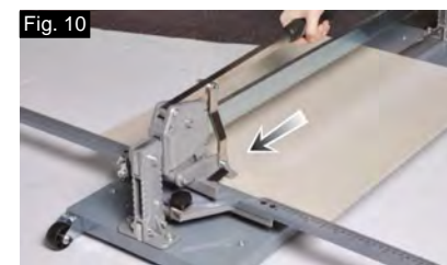
Fig 9 & 10 Bij gebruik van het kleine breeksysteem, duwt u doorlopend harder tot de tegel volledig gebroken is.
